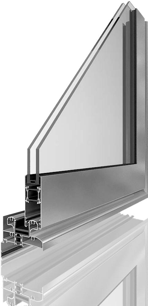
Cerco horizontal de 90 mm de anchura. Cerco lateral con 90 mm en parte exterior y 93,4 mm en interior, anchura del carril de rodadura en marco horizontal de 21 mm. Hojas con galce para doble acristalamiento hasta 29 mm. Con 86 mm de frente y 35,6 mm de profundidad con alojamiento para cepillo en hojas permitiendo su fácil sustitución. Posibilidad hoja ajunquillada y acabados bicolor.
