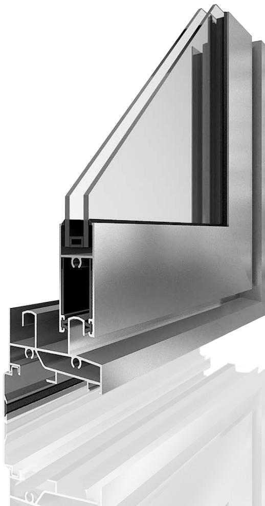
Cercos horizontales de 73,5 mm y cerco vertical de 77 mm, frente de 35 mm y anchura de rodadura de 12 mm.
