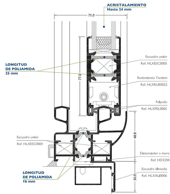
Valor Transmitancia Térmica y resultados de ensayos para Hueco 1.23x1.48 con vidrio tipo 4 - 10 - 4
