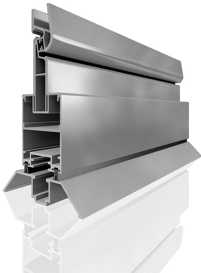
Sistemas de lamas, tanto fijas como regulables, de hasta 92,4 mm. Además de la solución de guías por fachadas hay opción de guías para colocar perimetralmente al hueco de obra. Hojas de 40 mm de ancho y 48 mm de frente. Compatible con la perfilería de la serie abisagrada mallorquina Diana.
