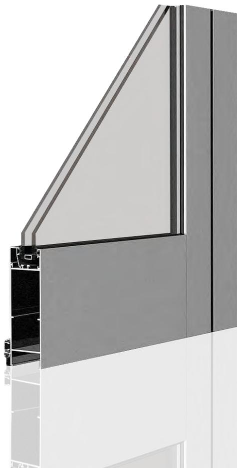
Sistema de carpintería practicable con canal de 25 mm. Sección de marco y hoja enrasados de 52 mm. Accesorios especiales para canal de 25 mm y juntas de estanqueidad en EPDM. Peso máximo aconsejado por hoja:
