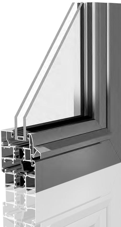
Cercos de 71 mm y hojas de 75 mm. Rotura de puente térmico con poliamida reforzada de 24 mm.
